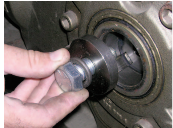
3. Remove shaft retaining bolt.
