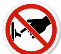
Appliance must not be supplied through an external switching device that is regularly switched on and off. / L'appareil ne doit pas être alimenté par un interrupteur externe régulièrement allumé et éteint. / El aparato no debe ser alimentado a través de un dispositivo de conmutación externo que se encienda y apague periódicamente.
